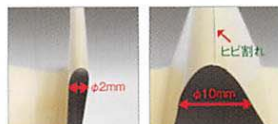
SPネオ無機コートII 従来の無機塗料 従来の無機塗料は、φ10mmの曲げ試験でひびが入りますが、SPネオ無機コートIIは、φ2mmでもひび割れが起きません。
